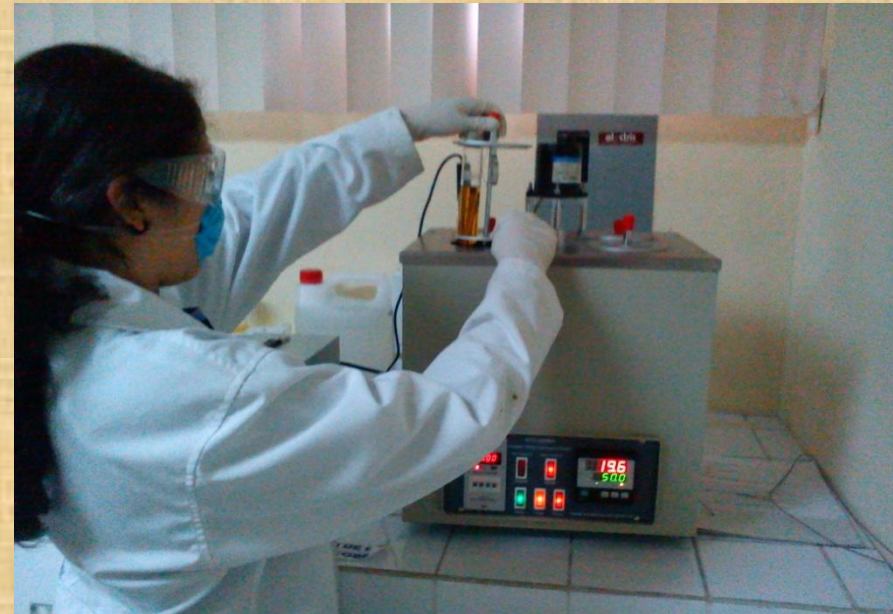
Corrosión a la Tira de Cobre
